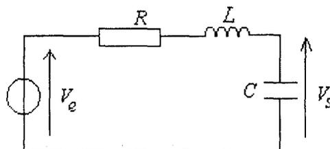
On pose  $Q$  et  $\omega_0$  tels que :  $Q = \frac{L\omega_0}{R}$  et  $LC\omega_0^2 = 1$  ; on prend le nombre complexe  $j$  tel que  $j^2 = -1$ .
