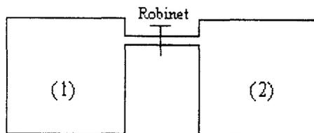
Les deux compartiments de volumes respectifs  $V_1$  et  $V_2$  sont rigides et parfaitement calorifugés ; ils communiquent par un robinet.
