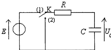
**I.1** - A l'instant de date  $t = 0$ , on place l'interrupteur  $K$  en position (1), le condensateur étant déchargé.
