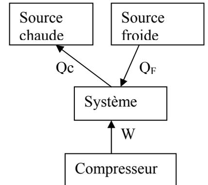
**I3)** Un changement d'état met en jeu des quantités d'énergie importantes. Ici la condensation « rapporte » beaucoup de transfert thermique à la source chaude. La température d'ébullition basse du fluide lui assure la possibilité de subir une ébullition à  $T_{\text{ext}}$  basse et donc avec une source extérieure naturelle.
