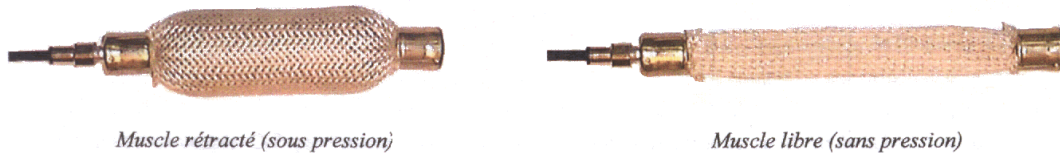
FIGURE 8.2 – Principe de génération d'effort.
