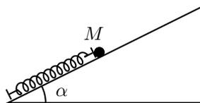
On comprime le ressort au maximum (c'est-à-dire en réduisant à longueur à 0) avant de le lâcher, ce qui propulse la bille. On montre que le contact entre le ressort et la bille est rompu dès que le ressort retrouve sa longueur à vide. On néglige tous les frottements.
