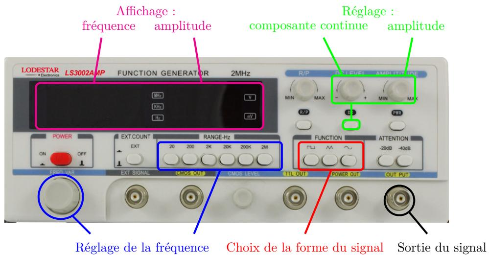
Un GBF permet de générer des signaux électriques périodiques de forme complètement déterminée. On utilisera la sortie nommée **OUTPUT**, en connectant un fil coaxial ou de préférence des fils usuels en utilisant un **adaptateur**.
