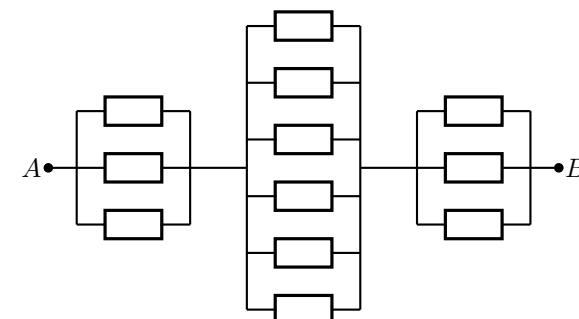
La résistance équivalente est  $R_{eq} = \frac{R}{3} + \frac{R}{6} + \frac{R}{3}$  soit  $R_{eq} = \frac{5R}{6}$ .
