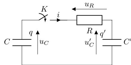
2. En utilisant les orientations ci-dessus, la loi des mailles s'écrit :  $-u_C + u'_C + u_R = 0$ . En dérivant on obtient :  $-\dot{u}_C + \dot{u}_{C'} + \dot{u}_R = 0$ . Or  $i = -C\dot{u}_C$  (convention générateur) et  $i = C'\dot{u}_{C'}$  et  $u_R = Ri$ , si bien que l'équation s'écrit :  $i/C + i/C' + Ri = 0$ . En posant  $\tau = \frac{RCC'}{C + C'}$ , l'équation se met sous la forme :  $\frac{di}{dt} + \frac{i}{\tau} = 0$ . La solution générale s'écrit  $i(t) = \lambda e^{-t/\tau}$ .
