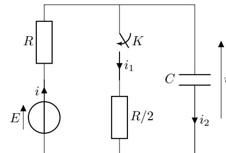
1. À  $t = 0^-$  le circuit est en régime stationnaire. Le condensateur est alors équivalent à un interrupteur ouvert, et il n'y a aucun courant dans le circuit :  $i(t = 0^-) = i_1(t = 0^-) = i_2(t = 0^-) = 0$ .
