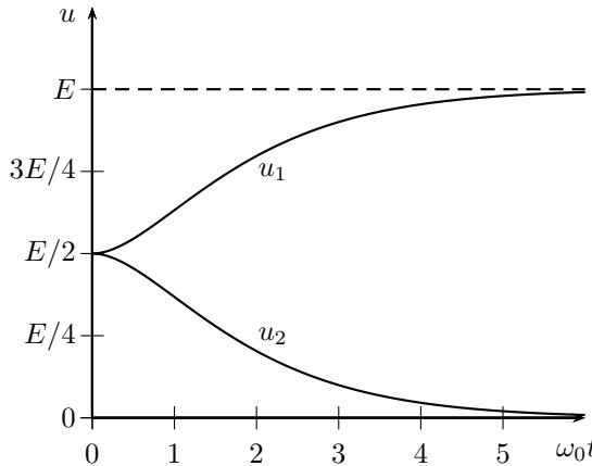
**II.10)** La puissance donnée au circuit par le générateur vaut  $\mathcal{P}_E = Ei_1(t) = EC \frac{du_1}{dt}$ .
