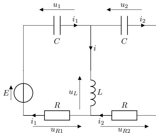
**II.4)** Dans le circuit ci-dessus pour  $t > 0$  on a  $i_1 = C \frac{du_1}{dt}$  et  $i_2 = C \frac{du_2}{dt}$ .
