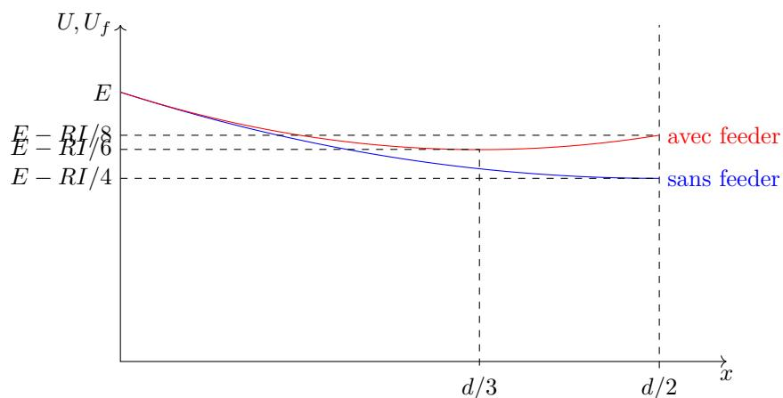
On a en tout point  $U_f > U$ . Le rôle du feeder est donc de diminuer la chute de tension au niveau des motrices lors du déplacement du TGV, et du même coup les pertes par effet Joule.
