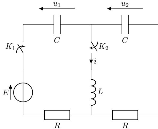
On ferme tout d'abord l'interrupteur  $K_1$ , l'interrupteur  $K_2$  restant ouvert, et on attend l'installation d'un régime permanent stationnaire.
