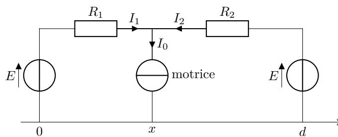
**I.1)** La tension d'alimentation est en réalité alternative de fréquence 50 Hz. Justifier que l'ARQS est valable sur le tronçon entre les stations d'alimentation. On supposera par la suite le régime stationnaire.
