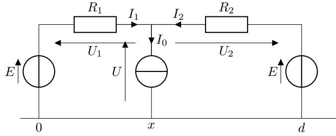
En appliquant la loi des mailles, on obtient  $E = U_1 + U$  et  $E = U_2 + U$  donc  $U_1 = U_2$ . La loi d'Ohm donne alors  $R_1 I_1 = R_2 I_2$ . De plus la loi des nœuds s'écrit  $I_1 + I_2 = I_0$  donc  $I_2 = I_0 - I_1$  et  $R_1 I_1 = R_2 (I_0 - I_1)$ .
