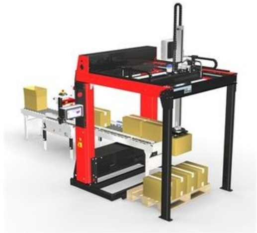
Nous nous intéressons à la commande de l'axe x . FIGURE 7.1 – Robot cartésien de tri.
