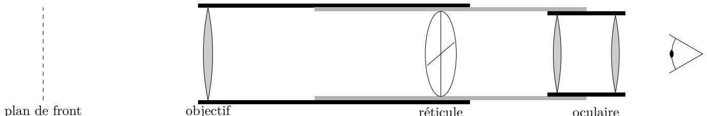
Sur nos appareils, le réticule est solidaire de l'oculaire, aucun réglage n'est nécessaire, l'oculaire sera enfoncé complètement.
