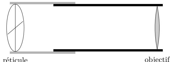
La distance réticule-lentille doit être réglée de façon à donner une image à l'infini de ce réticule. Pour ce faire, on utilise une lunette réglée à l'infini :
