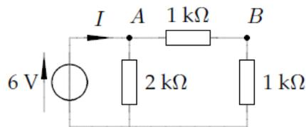
Et finalement, on se ramène à un générateur idéal de tension débitant un courant  $I$  dans un résistor unique de résistance  $R = 1 \text{ k}\Omega$ .
