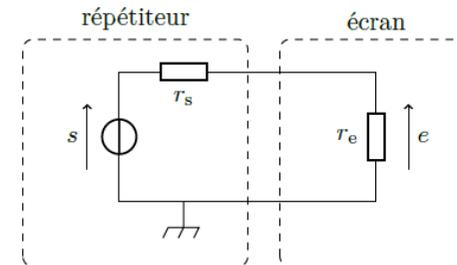
2. Les résistances  $r_e$  et  $r_s$  sont montées en série et forment un diviseur de tension, d'où  $\frac{e}{s} = \frac{r_e}{r_s + r_e} = \frac{1}{2}$ . Par conséquent,  $s$  doit avoir une amplitude de  $2V$  pour que  $e$  ait une amplitude de  $1V$ .
