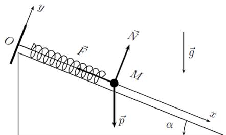
On se place à l'équilibre alors  $\vec{P} + \vec{N} + \vec{F} = \vec{0}$ . On projette cette équation suivant l'axe  $Ox$  car la réaction du support est inconnue. On a donc  $k(l_{eq} - l_0) = mgsin(\alpha)$  soit  $l_{eq} = l_0 + \frac{mgsin(\alpha)}{k}$ .
