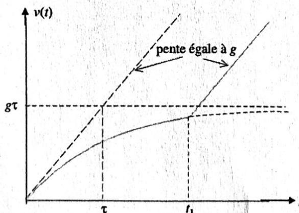
5. Comme on l'a vu, il y a freinage par induction dans la première phase, pour  $t \in [0, t_1]$ . Cela se traduit par une diminution de l'accélération.
