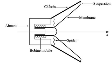
L'ensemble {bobine + membrane} est un solide de masse  $m$ , mobile en translation selon l'axe (Oz). Le spider et la suspension exercent sur cet ensemble une force de rappel élastique vers la position d'équilibre  $z = 0$  :
