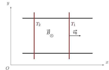
Un champ magnétique  $\vec{B}$  permanent, uniforme et vertical, règne en tout point de l'espace. À l'instant initial, on communique à la tige  $T_1$  une vitesse  $\vec{v}_0 = v_0 \cdot \vec{u}_x$  ( $v_0 > 0$ ) tandis que  $T_2$  est immobile. On néglige les effets dus au champ propre.
