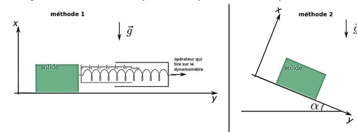
**Méthode 1 :** Le plan de travail est horizontal. On tire sur l'objet à l'aide d'un dynamomètre, jusqu'à ce que l'objet soit entraîné. Au moment où il est entraîné, on note la valeur de la force  $F$  lue sur le dynamomètre.
