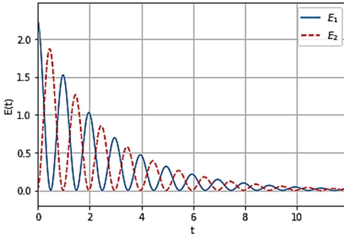
On constate que pour l'oscillateur amorti l'énergie totale **diminue au cours** du temps à cause de l'amortissement qui **dissipe de l'énergie**.
