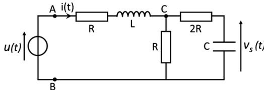
**Q3.** Quelle relation lie  $\underline{u}$ ,  $\underline{i}$  et  $\underline{Z}_{AB}$  l'impédance équivalente du dipôle AB ?
