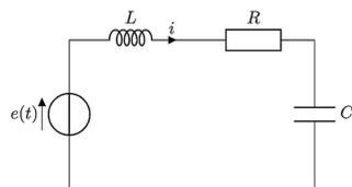
Q2. On cherche  $i(t)$  sous la forme  $i(t) = I_0 \cdot \cos(\omega t + \varphi)$ . Par quelle expression complexe ce signal est-il représenté ?
