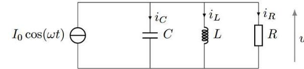
**Q1.** Déterminer l'impédance complexe de l'association équivalente à l'antenne.
