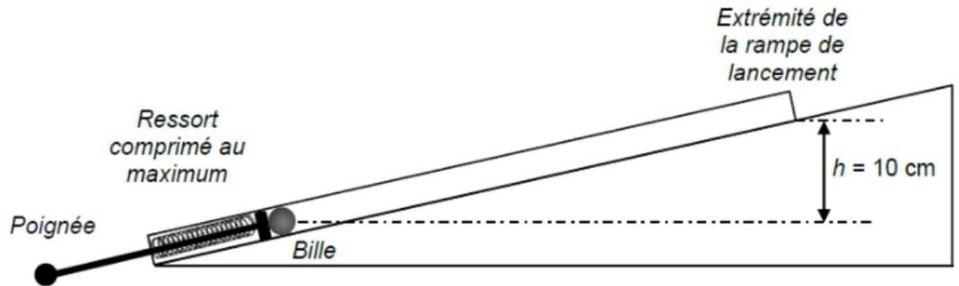
Caractéristiques : raideur  $33 \text{ N.m}^{-1}$  ; écrasement maximal  $\Delta\ell = 90 \text{ mm}$ .
