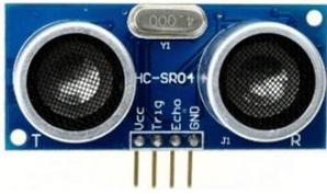
Le capteur de distance (aussi appelé capteur ultrason) permet de réaliser des mesures de distance. Il permet d'estimer une distance allant de 2 cm à 400 cm avec une précision de 3mm. C'est le capteur de distance le plus utilisé et le moins cher. Vous pouvez l'utiliser pour diriger un robot, faire un radar de recul pour voiture et bien plus encore.
