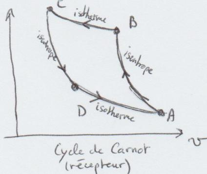
Q2 :  $e_c = \frac{Q_1}{W}$  or d'après le 1<sup>er</sup> principe  $\Delta U = W + Q_1 + Q_2$  et  $\Delta U = 0$  (cycle)
