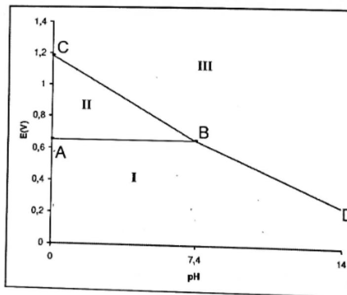
Figure 2 - Diagramme E-pH de l'iode
