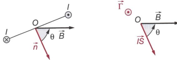
La puissance du couple de Laplace lors de la rotation du cadre autour de son axe de symétrie, à la vitesse angulaire  $\vec{\Omega} = \omega \cdot \vec{u}_\Delta$  vaut :  $P_L = (\vec{\mathcal{M}} \wedge \vec{B}_{ext}) \cdot \vec{\Omega}$
