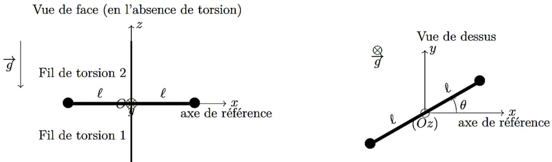
Le système évoluant dans l'air, on supposera que les masses sont chacune soumises à une force de frottements visqueux de la forme  $\vec{F}_f = -h \cdot \vec{v}$  où  $h$  est une constante positive et  $\vec{v}$  est la vitesse de la masse. On négligera les frottements s'exerçant sur la tige.
