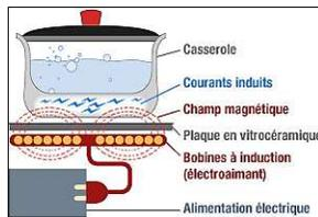
Du point de vue électromagnétique, on modélise le fond de casserole par une spire circulaire unique, fermée sur elle-même, appelée induit. L'induit a une résistance  $R_2 = 8,3 \text{ m}\Omega$  et une auto-inductance  $L_2 = 0,24 \text{ }\mu\text{H}$ . Le transfert d'énergie électrique s'effectue par couplage inductif entre l'inducteur et l'induit d'inductance mutuelle  $M = 2 \text{ }\mu\text{H}$ .
