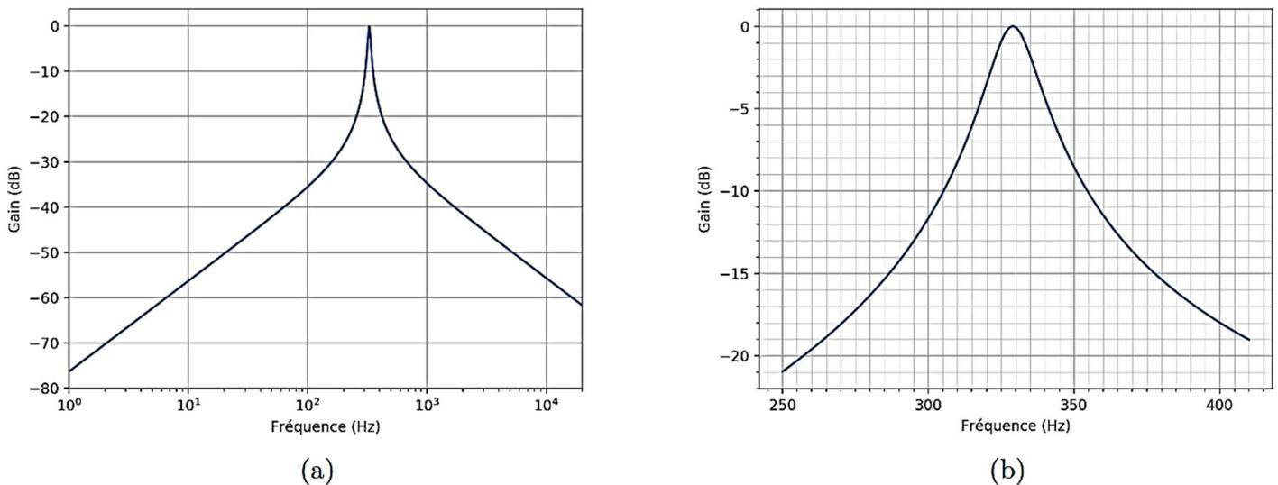
**Figure 4** - Diagramme de Bode en gain du filtre ( $F_b$ )
