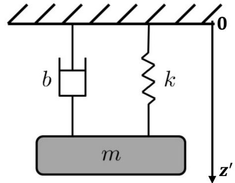
Pour simplifier la description on change de repère : on fixe l'origine au point d'attache du ressort et on prend un axe  $Oz'$  orienté vers le bas.
