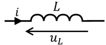
Le coefficient  $L$  caractérise la bobine et s'appelle l'**inductance** (*propre*) de la bobine. Il s'exprime en henry (H).
