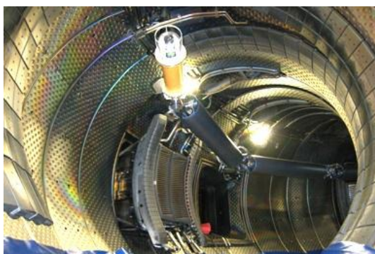
Figure 7a, vue du bras AIA en phase d'inspection à l'intérieur du Tore Supra
