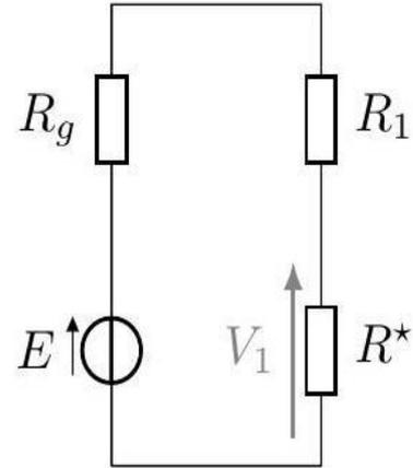
2- Si le voltmètre est idéal, sa résistance peut être considérée comme infinie et le voltmètre peut être remplacé par un interrupteur ouvert donc  $R^* = R$
