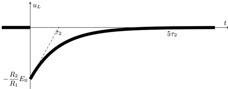
Les tensions  $u_L$  et  $u_2$  aux bornes de la bobine et de la résistance  $R_2$  sont discontinues en  $t = 0$ .
