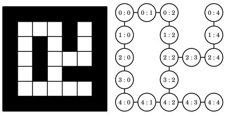
Figure 1 : Exemple de labyrinthe et de graphe associé
