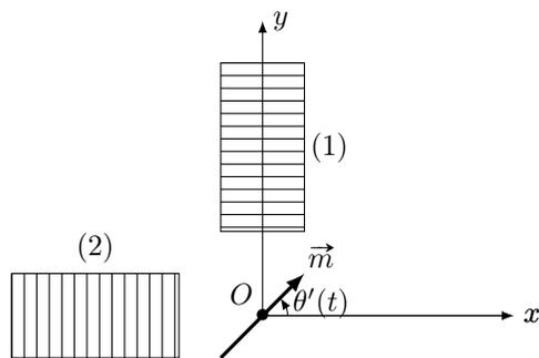
Un moteur synchrone peut être modélisé de façon très simplifiée par un aimant (rotor) tournant autour de l'axe  $(Oz)$ , de moment magnétique  $\vec{m}$  constant et situé dans le plan  $(xOy)$ . Il est repéré par l'angle  $\theta'(t)$  et nous n'envisageons que la possibilité d'une rotation à vitesse angulaire constante  $\omega'$  :  $\theta'(t) = \omega't - \theta_0$  où  $\theta_0$  est une constante.
