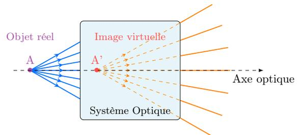
FIGURE 2.14 – Objet réel et image virtuelle.
