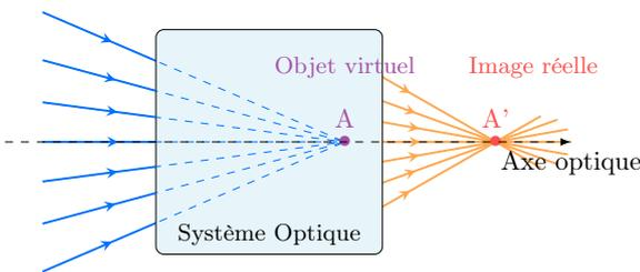
FIGURE 2.15 – Objet virtuel et image réelle.
