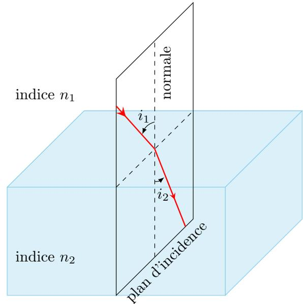
FIGURE 2.7 – Réfraction d'un rayon incident avec  $n_2 > n_1$ .
