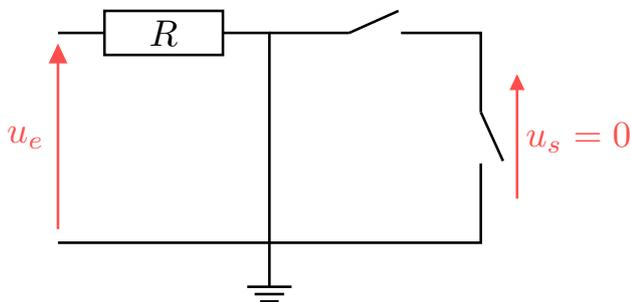
En hautes fréquences ( $\omega \rightarrow \infty$ ), les condensateurs se comportent comme des fils, la bobine comme un interrupteur ouvert : la tension  $u_s$  est donc nulle.
