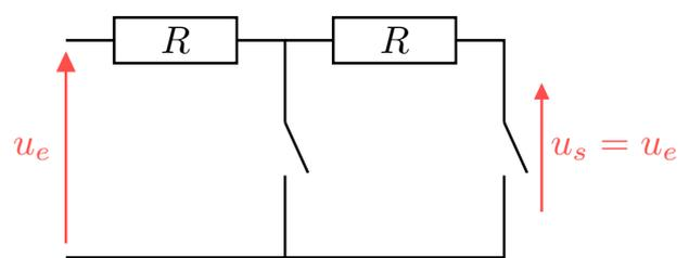
Ainsi, le signal de sortie est non nul pour les hautes fréquences, et négligeable pour les basses fréquences : c'est un **filtre passe-haut**. Il permettra d'obtenir les signaux informatiques.
