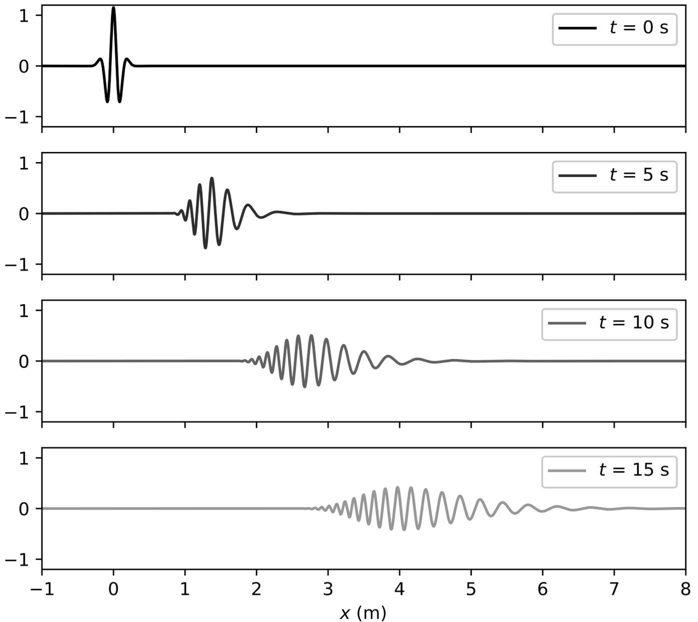
**FIGURE ON1.4** – Propagation dispersive d’une onde à la surface de l’eau. On observe nettement que les composantes sinusoïdales de hautes fréquences se propagent avec une moins grande vitesse que les composantes de basses fréquences. En ordonnée, l’unité de la hauteur d’eau est arbitraire.
