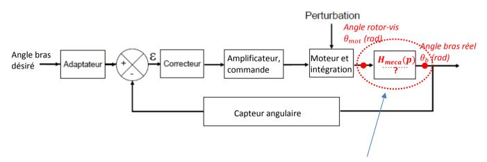
Problématique du TP : déterminer la fonction de transfert mécanique
