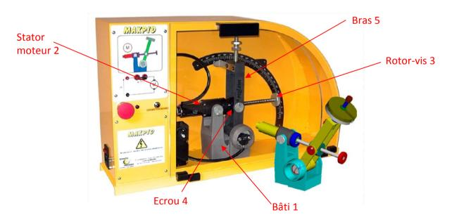
Le mécanisme permet d'asservir la position angulaire d'un bras (auquel on peut attacher des masses différentes). Ce bras est mis en mouvement par l'intermédiaire d'une vis entraînée par un moteur. Un capteur potentiomètrique permet de mesurer la position angulaire du bras par rapport au châssis. Une génératrice tachymétrique permet de mesurer la vitesse angulaire de l'arbre moteur.
