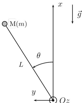
Une masse ponctuelle  $m$  est placée à l'extrémité M d'une tige de masse négligeable et de longueur  $L = OM$ , articulée en O et mobile dans un plan vertical. Un ressort « spirale » (non représenté sur la figure) exerce sur M, via la tige, un couple de rappel (notion abordée au chapitre 8) équivalent à un moment de force  $\vec{M}_O = -C\theta\vec{u}_z$ , avec  $C > 0$ .
