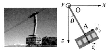
On note  $J_{\text{tot}}$  le moment d'inertie de l'ensemble par rapport à l'axe de rotation  $y$ , et la liaison est supposée parfaite. On effectue un test d'oscillations de la benne, le point O étant maintenant fixe.
