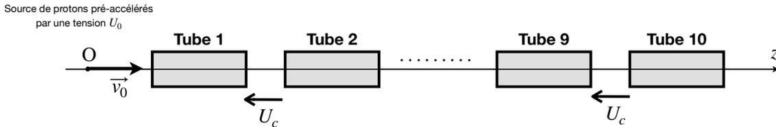
FIGURE C6.5 – Schéma du Linac 2.
