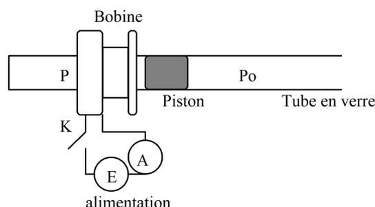
En faisant varier la fréquence du courant dans la bobine, on recherche la résonance en amplitude du piston. La fréquence de résonance est liée au coefficient adiabatique  $\gamma$  de l'air que l'on se propose de déterminer.
