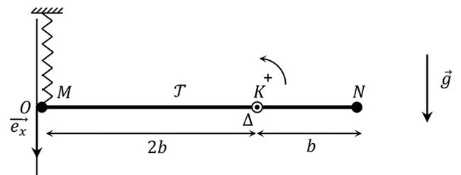
L'axe de rotation, orienté positivement vers le lecteur, sépare la tige en deux parties de longueurs  $MK = 2b$  et  $KN = b$ . Les frottements sont négligés. Le moment d'inertie de  $\mathcal{T}$  par rapport à  $\Delta$  vaut  $mb^2$ .
