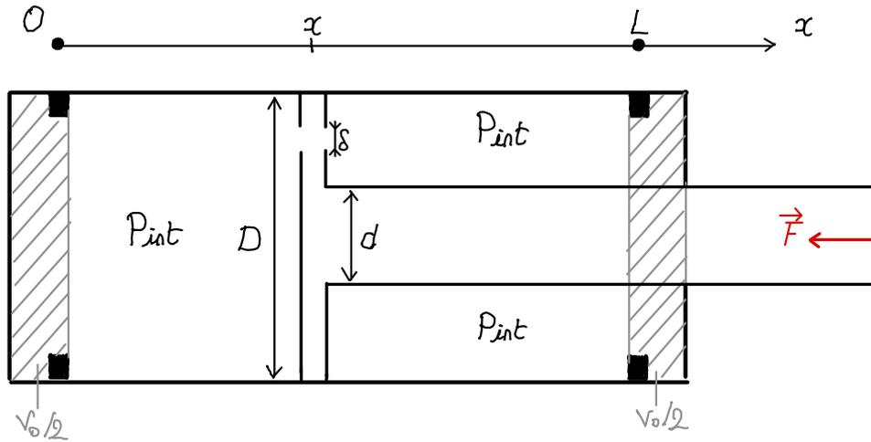
Le piston a une épaisseur nulle, et on pourra négliger la section de l'orifice de communication de diamètre  $\delta$  devant les autres sections. On note  $V_0$  l'ensemble des deux volumes morts que le piston ne peut atteindre, situés en  $x < 0$  et  $x > L$ . On prendra également  $D = 2d$ . On supposera que l'équilibre thermique du gaz avec l'air extérieur de température  $T_0$  est réalisé pour toute position du piston, et on note  $P_0$  la pression extérieure.
