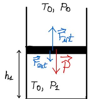
② Même système, mêmes forces avec  $\vec{F}_{\text{int}} = P_2 S \vec{u}_z$  et  $P_2 h_2 S = nRT$ , d'où
