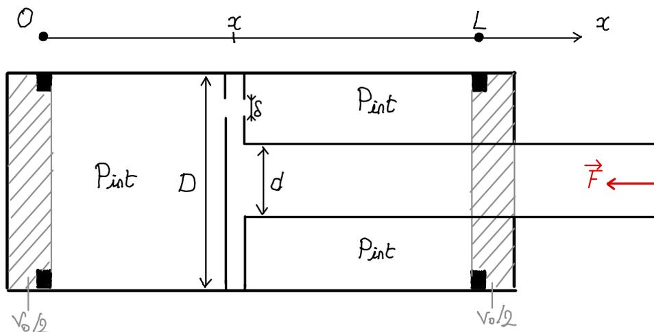
Le piston a une épaisseur nulle, et on pourra négliger la section de l'orifice de communication de diamètre  $\delta$  devant les autres sections. On note  $V_0$  l'ensemble des deux volumes morts que le piston ne peut atteindre,
