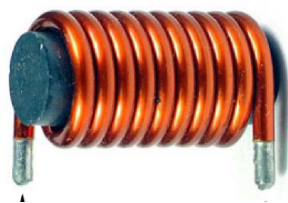
FIGURE I1.8 – Photo et représentation d'un solénoïde avec lignes de champ.
