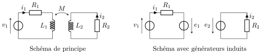
**FIGURE I3.3** – Schémas équivalents à une plaque à induction.
