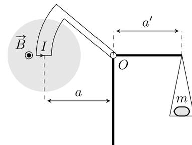
La balance peut tourner sans frottements dans le plan de la figure autour du point O. À vide, c'est-à-dire sans champ magnétique ni masse  $m$ , la position du plateau est ajustée afin que la balance soit à l'équilibre avec le bras de droite parfaitement horizontal.
