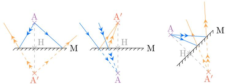
FIGURE O3.1 – Constructions optiques de miroirs plans.
