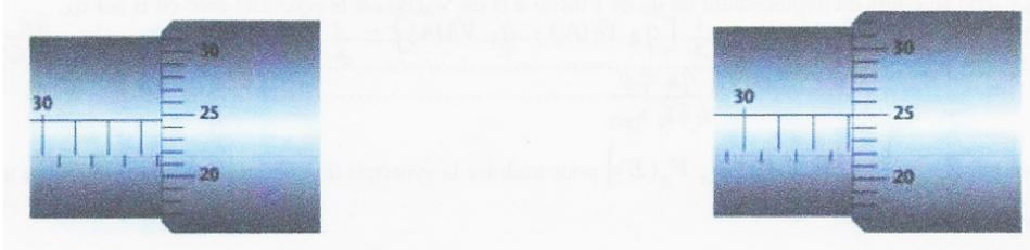
FIGURE TP2.1 – Principe de lecture sur une vis micrométrique. Un tour complet correspond à 0,5 mm.
