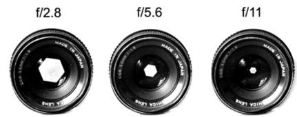
FIGURE O4.25 – Exemples d'ouvertures.
