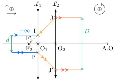
Si  $D$  est le diamètre du faisceau final et  $d$  celui du faisceau initial, alors en utilisant le théorème de THALÈS dans les triangles  $F_2II'$  et  $F_2JJ'$ , on trouve
