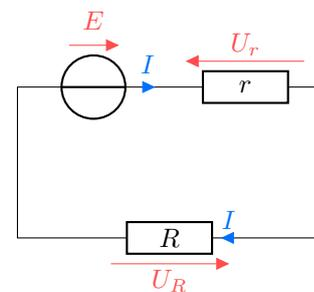
3 Déterminer l'expression de l'intensité du courant qui circule dans le circuit.
