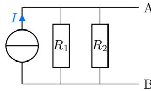
1 Exprimer les tensions aux bornes de  $R_1$  et  $R_2$  dans le montage ci-contre.
